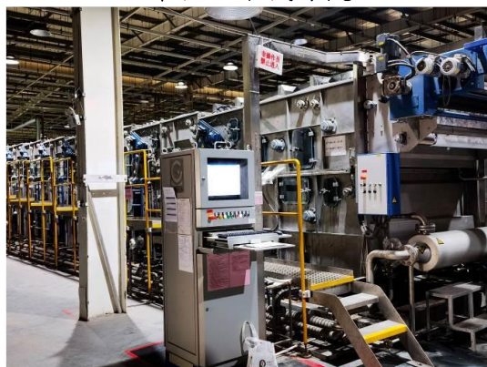
平幅水洗機操作臺
